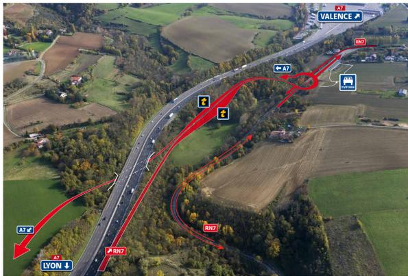
La **variante nord** est située au nord de la zone d'études, entre la barrière de péage en pleine voie et le demi-échangeur existant, dans un secteur au relief complexe. Elle nécessite la création d'un ouvrage en tranchée couverte sous l'autoroute A7.
